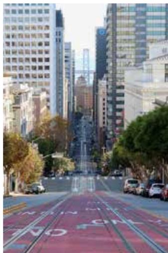
サンフランシスコのケーブルカーは現役かつ世界最古の手動運転の循環式ケーブルカーで、ケーブルはレールとレールの真ん中の路面下に設置されていて、約時速15kmで丘の上のモーターで巻き上げられています。巨大なモーターが設置してある所は、ケーブルカー博物館として公開されていました。この大きな車輪のような巻上機が大きな音を立てて常時回っており、これがケーブルカーの動力源です。
